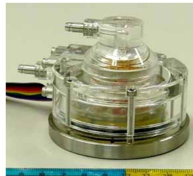
図1 試作した遠心血液ポンプ(DP2)
